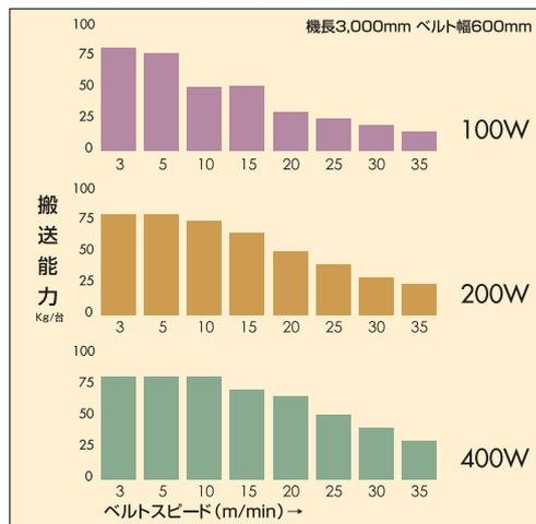
■グラフは水平分散荷重時の能力です。袋物の搬送は、40%以下の設定でご使用下さい。
