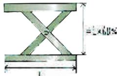
ストローク目安=リフター段数×リフター架台のL寸法×0.6
